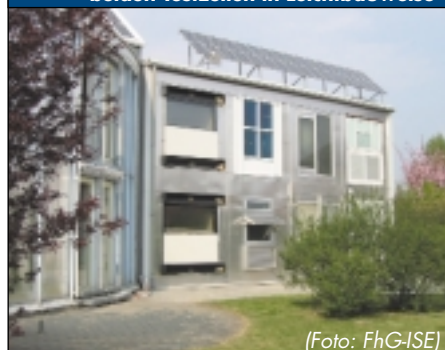
Abb 5: Fassadenteststand des Fraunhofer-ISE: außen links übereinander die beiden Testzellen in Leichtbauweise
